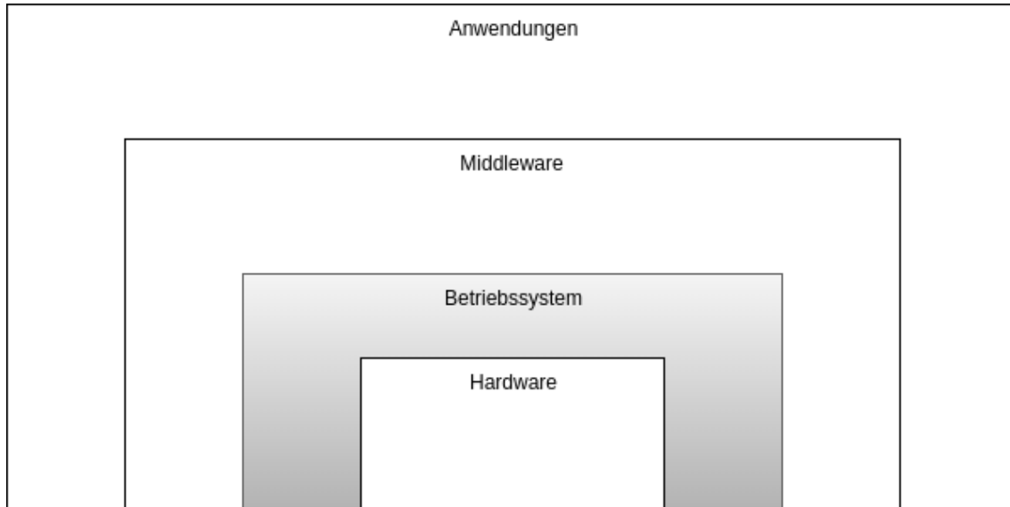
Abbildung 2.2: Positionierung eines klassischen Betriebssystems [Kao, S. 13]
